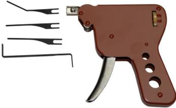
Bei der manuell betriebenen Pick-Pistole werden durch Betätigen des Abzugs einzelne, harte Schläge ausgelöst. Diese Schläge werden durch die Picknadel auf die Zuhaltungsstifte in den Schließzylindern übertragen. Der Perkussionseffekt entsteht. Der Schlaghub ist regulierbar. Das Picken mit diesem Werkzeug erfordert einiges an Geschick.
